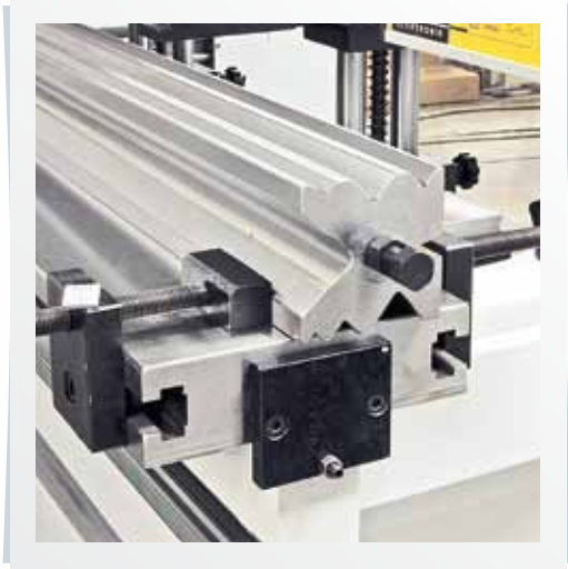
Çoklu Alt Kalıp. (opsiyon) Multi V ya da U tipi ayarlanabilir kalıplar.
