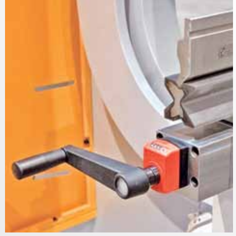
Manüel Bombeleme Sistemi. (opsiyon) Bükülen parçanın her noktada ve eşit büküm açısında olmasını sağlayan manüel bombeleme sistemi.
