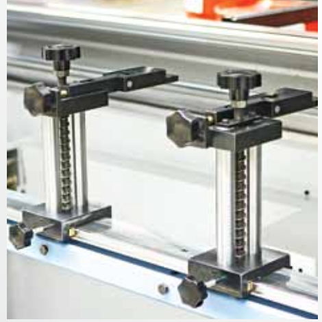
Arka Dayama Dilleri. (opsiyon) Özel tasarlanmış katlanabilir arka dayama dilleri.
