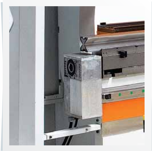
Motorlu Bombeleme Sistemi. (opsiyon) CNC kontrolörlü haberleşim otomatik bombeleme yaparak, bükülen parçanın her noktada ve eşit büküm açısında olmasını sağlayan motorlu bombeleme sistemi.
