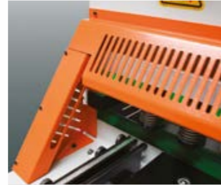
Lichtvorhänge für Fingerschutz (optional) Für besonders sichere schnelle und einfache Handhabung der Bleche.
