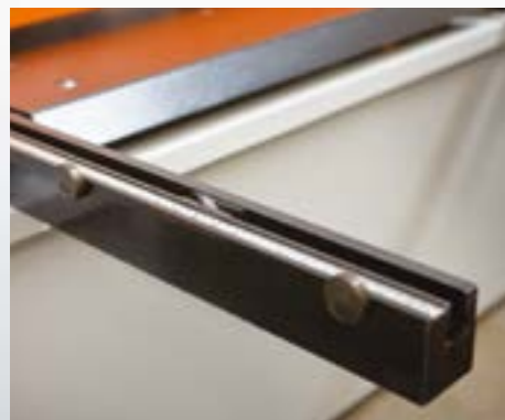
Auflage mit Seitenanschlag Einfache Handhabung des Werkstücks und Vorschub in den Arbeitsbereich, dadurch feinere und schnellere Schnitte
