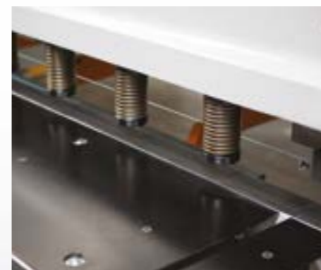
Schattenlinie (serienmäßig) Qualifiziertes und sensibles Schneiden durch richtiges Positionieren des Blechs mit Hilfe der Schattenlinie an der Schnittkante
