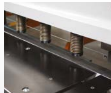
Schattenlinie (serienmäßig) Qualifiziertes und sensibles Schneiden durch richtiges Positionieren des Blechs mit Hilfe der Schattenlinie an der Schnittkante
