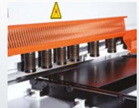
Abklappbarer Fingerschutz (serienmäßig) Für Winkelschnitte und Orientierung an Risslinien ist das Vorderteil des Fingerschutzes durch den Bediener anhebbar (mit Schalterschutz)
