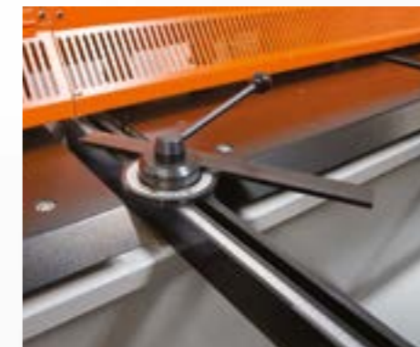
Winkelkopf (optional) Präzises und einfaches Anlegen des Blechs bei Winkelschnitten
