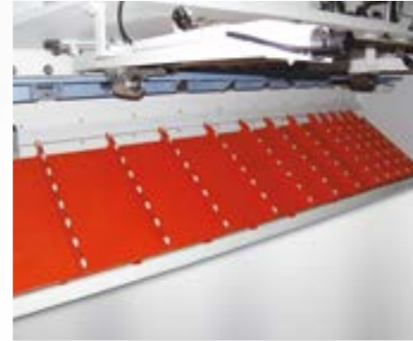
Pneumatische Werkstückklauflage in Tischbauweise (optional) Verhindert Herabhängen breiter und dünner Bleche durch pneumatischen Auflagetisch und trägt so zu präziseren Schnitten bei
