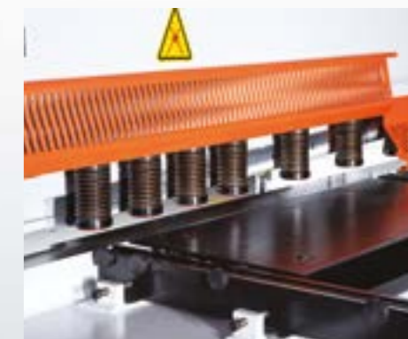
Откидная защита пальцев. (стандарт) Для контроля угловых разрезов и начерченных линий, оператор может поднять переднюю часть защиты. (Защищено выключателем)
