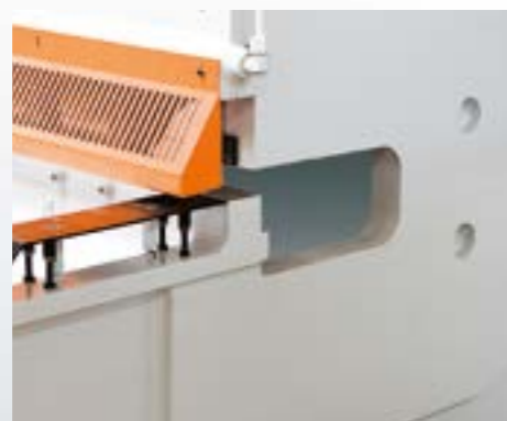
Паз. (стандарт) Глубина стандартного паза в 350мм позволяет резать листы металла, длина которых больше длины станка.
