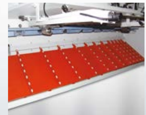
Pneumatische Werkstückauflage in Tischbauweise (optional) Verhindert Herabhängen breiter und dünner Bleche durch pneumatischen Auflagetisch und trägt so zu präziseren Schnitten bei.
