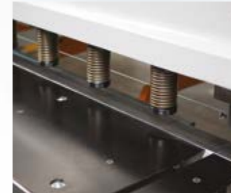
Schattenlinie (serienmäßig) Qualifiziertes und empfindliches Schneiden durch Schattenwurf an der Schnittlinie zur Blechpositionierung.
