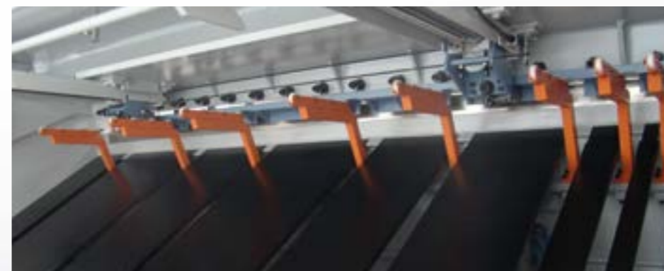
Рычажная пневматическая система поддержки листа (опцион) Устраняет свес широких и тонких листов посредством пневматических опорных кронштейнов и обеспечивает более точные разрезы.
