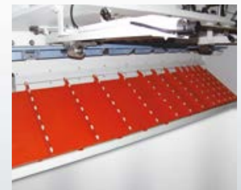
Моноблочная пневматическая система поддержки листа (опцион) Устраняет свес широких и тонких листов посредством пневматических опор стола и обеспечивает более точные разрезы.
