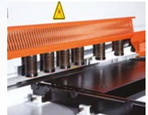
Откидная защита пальцев. (стандарт) Для контролирования угловых разрезов и начерченных линий, оператор может поднять переднюю часть защиты. (Защищено выключателем)
