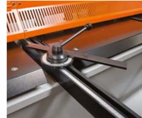
Açılabilir gönye. (opsiyon) Açılı kesimlerde, yüksek hassasiyetli, kolay kesim yapabilme imkanı sağlar.
