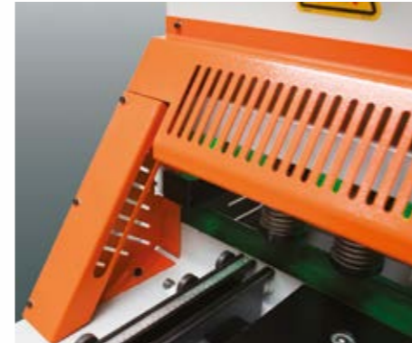
Işıklı parmak koruma. (opsiyon) Yüksek güvenlik koruması ile kolay ve hızlı çalışma imkanı sağlayan ışıklı parmak koruma sistemi.
