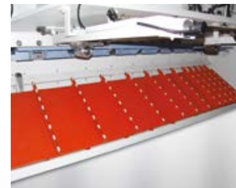
Pneumatische Blechauflage Klapptisch (optional) Verhindert Herabhängen breiter und dünner Bleche durch pneumatischen Aufagetisch und trägt so zu präziseren Schnitten bei
