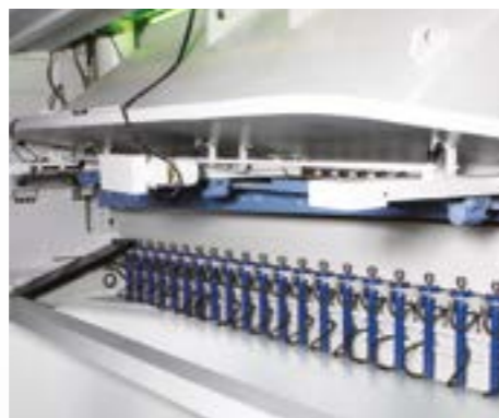
Verdrillschutz (option) Der Verdrillschutz verhindert Verdrillen schmaler Blechstreifen und hält diese entgegen der Messerbewegung beim Schneiden gerade
