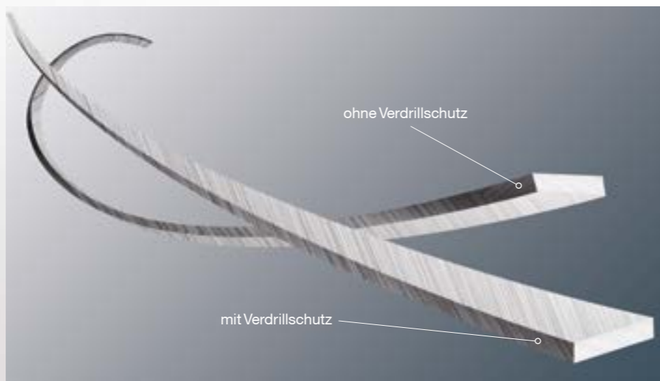
Verdrillschutz (option) Der Verdrillschutz verhindert Verdrillen schmaler Blechstreifen und hält diese entgegen der Messerbewegung beim Schneiden gerade
