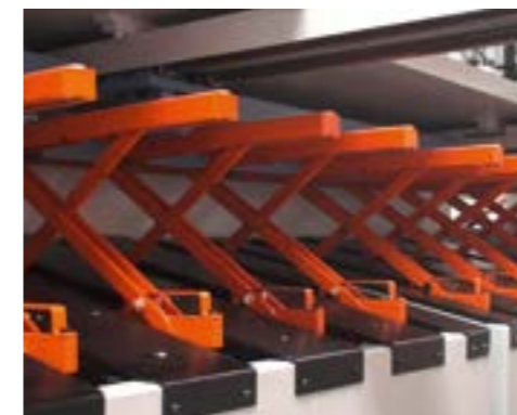
Pneumatische Blechauflage Schere (optional) Schützt herabhängende Bleche und erhöht die Genauigkeit beim Verarbeiten langer und dünner Bleche, die Besonderheit an diesem System ist die parallele Abwärtsbewegung zusammen mit dem Blech und dessen Abstützung während des gesamten Schneidvorgangs
