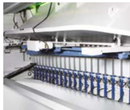
Verdrillschutz (option) Der Verdrillschutz verhindert Verdrillen schmaler Blechstreifen und hält diese entgegen der Messerbewegung beim Schneiden gerade
