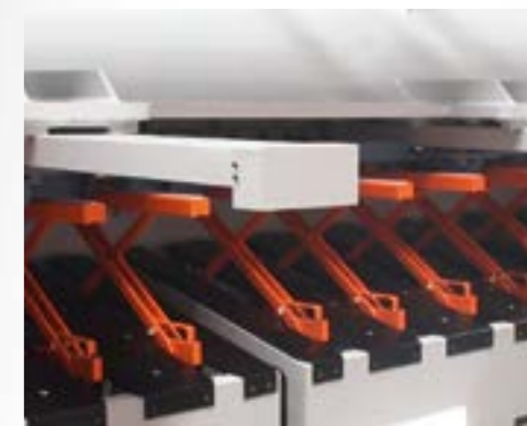
Rückführsystem (optional) Präzise geschnittene Bleche durch hintenliegende pneumatische Blechauflage mit Herausführung nach vorne
